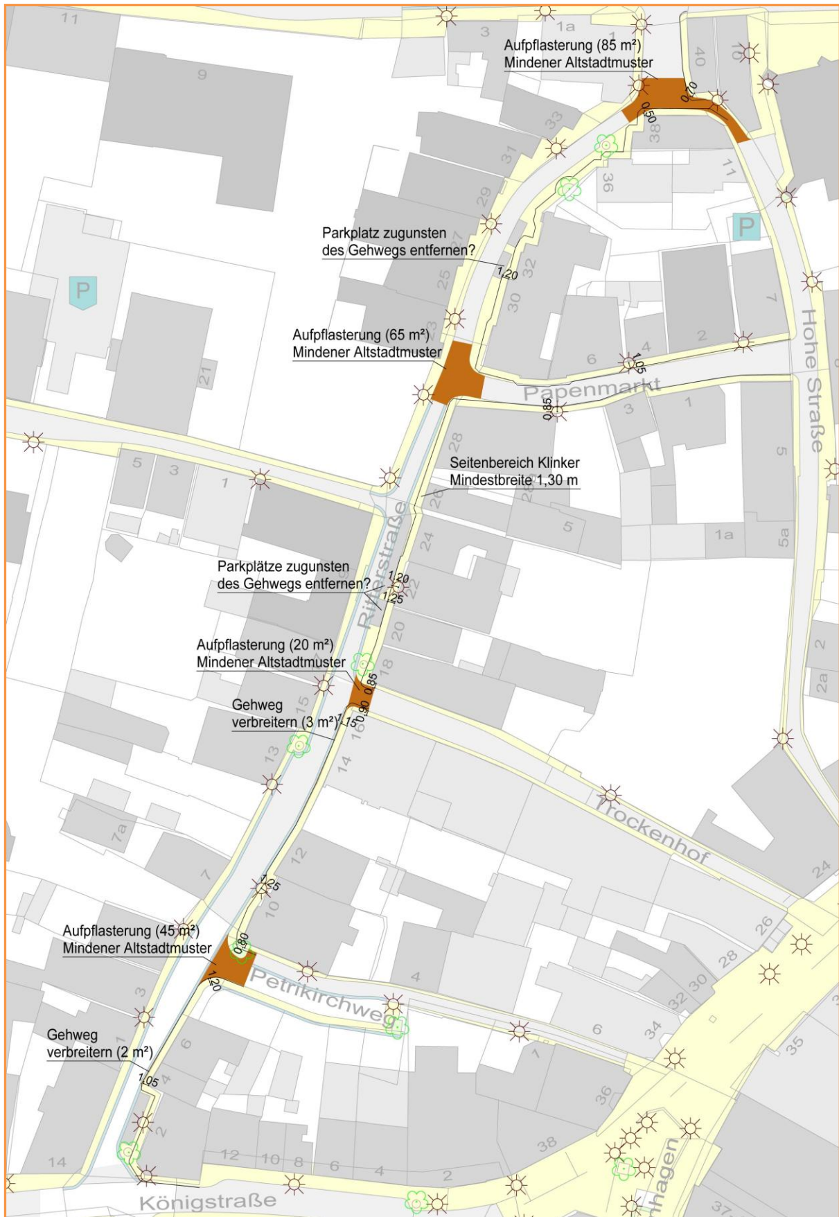
Abbildung 69: Lösungsvorschläge Ritterstraße östlicher Gehweg - Variante A
